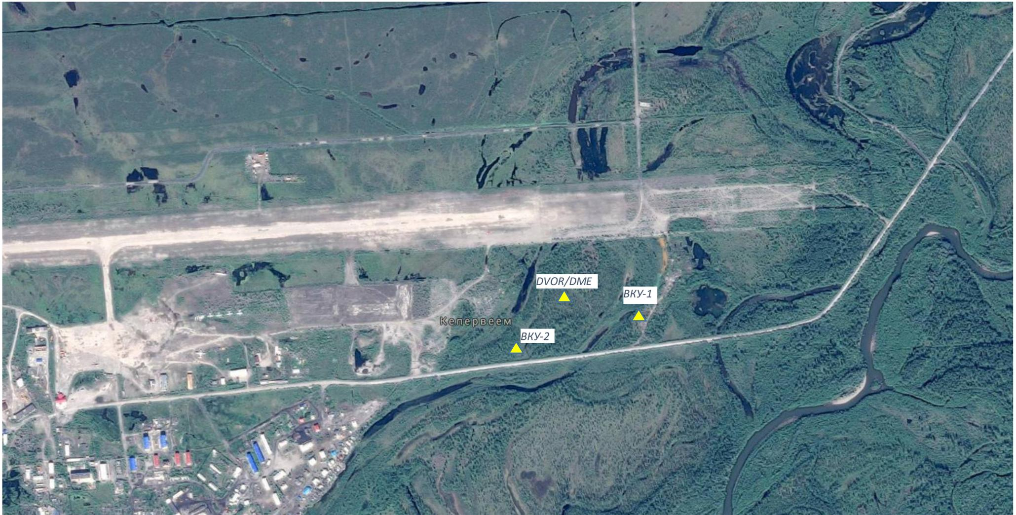
Схема расположения оборудования DVOR2000/DME/N2700, ВКУ-1 и ВКУ-2 в районе аэродрома Кепервеем
