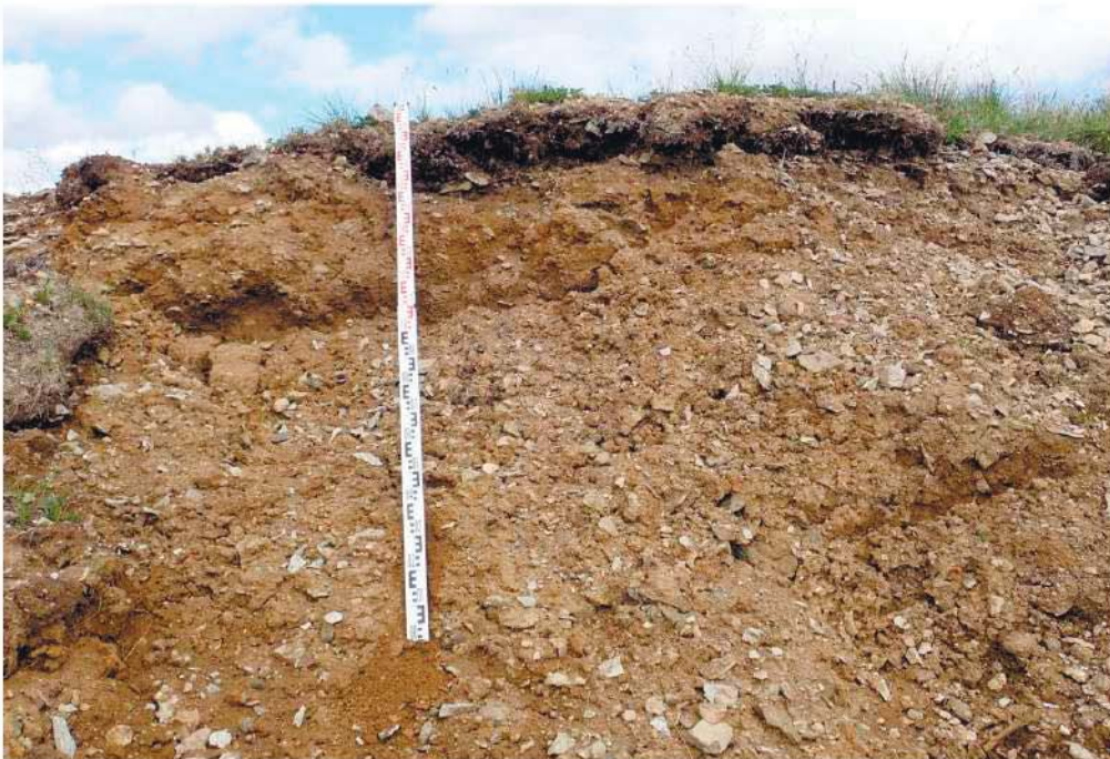
Рис. 32. Обследованное техногенное обнажение стенки карьера. Характер рыхлых отложений. Вид с юга.
