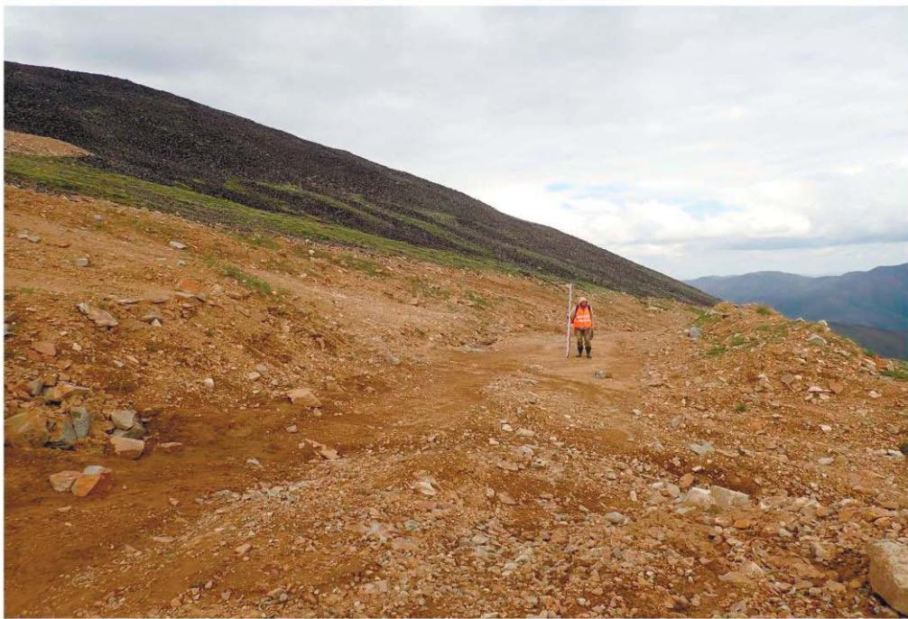
Рис. 13. Участок 1. Характер местности, вид с востока. Северный склон возвышенности, сложенный курумником, технологический проезд и выборки породы.
