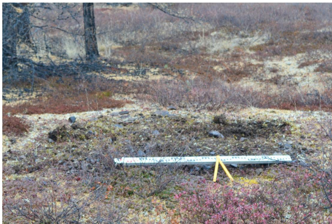
Рис. 59. Фото. Билибинский район ЧАО. Участок проектируемой трассы автодороги Колыма – Омсукчан - Омолон – Анадырь, км. 440+000 - км. 425+000. Останец моренного происхождения в районе км. 428. Расчистка дернового слоя в центральной части вершины останца. Вид с Ю.
