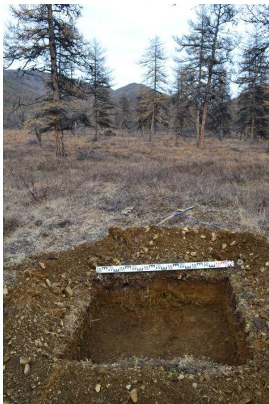
Рис. 31. Фото. Билибинский район ЧАО. Участок проектируемой трассы автодороги Колыма – Омсукчан - Омолон – Анадырь, км. 440+000 - км. 425+000. ПГСМ №3. Восточная стенка шурфа № 3. Вид с З.
