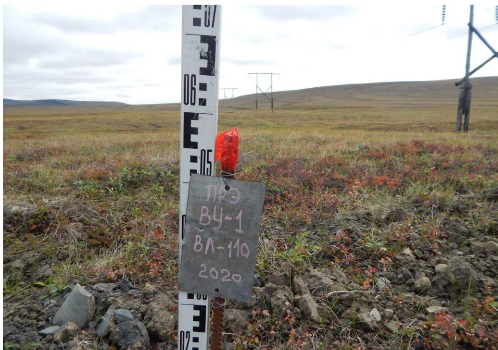
Рис. 17. Реперный знак на месте размещения проектируемой подстанции 110/10 кВ.
