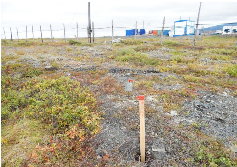
Рис. 121. Разведочная буровая скважина на участке строительства ВЛ 110 кВ в районе подключения к складскому комплексу. 138
