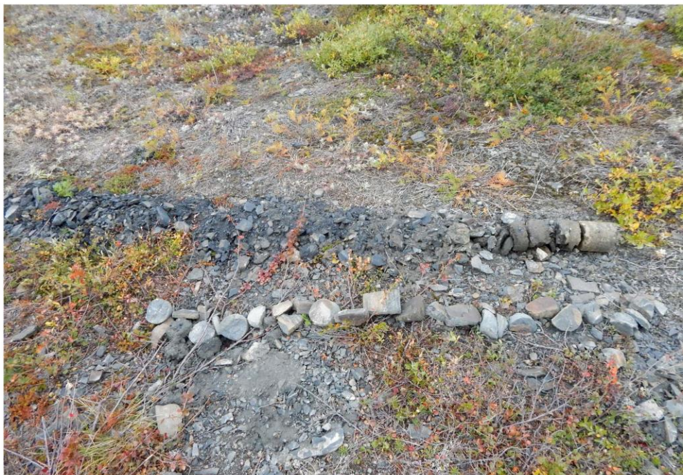
Рис. 129. Щебень и суглинок в разведочной буровой колонке в створе трассы ВЛ 110 кВ.
