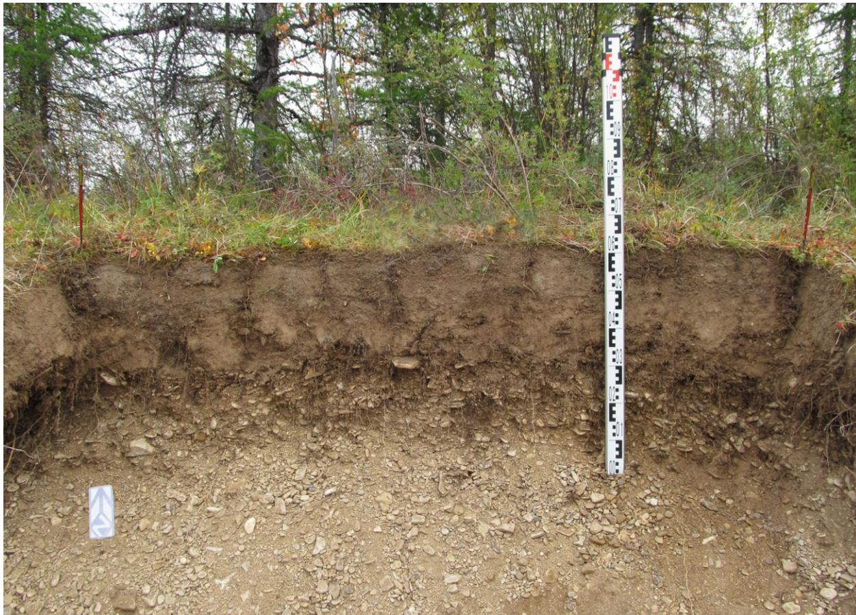
Рис. 29. Проектируемый объект «Временная дорога к Аэропорту» на месторождении «Песчанка». Характер рыхлых отложений зачистки № 4. Вид с юга.
