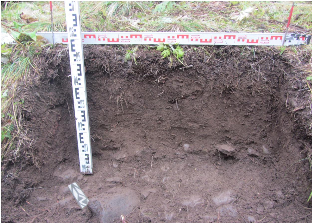
Рис. 31. Проектируемый объект «Временная дорога к Аэропорту» на месторождении «Песчанка». Характер рыхлых отложений зачистки №. 5. Вид с юго-востока.
