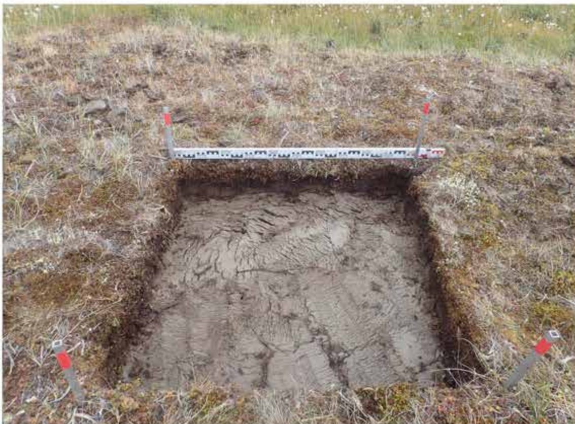
Рис. 74 . «Строительство универсального мор. терминала в р-не м. Наглёйнын». Характер рыхлых отложений шурфа № 5. Восточная стенка.
