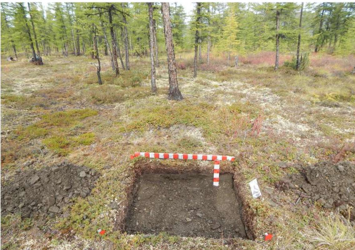
Рис. 69. Характер рыхлых отложений шурфа № 9. Вид с юга.
