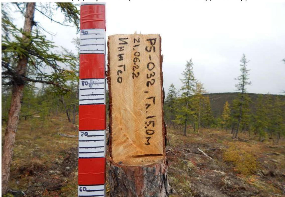
Рис. 23. Маркировка буровой разведочной скважины. Вид с запада.
