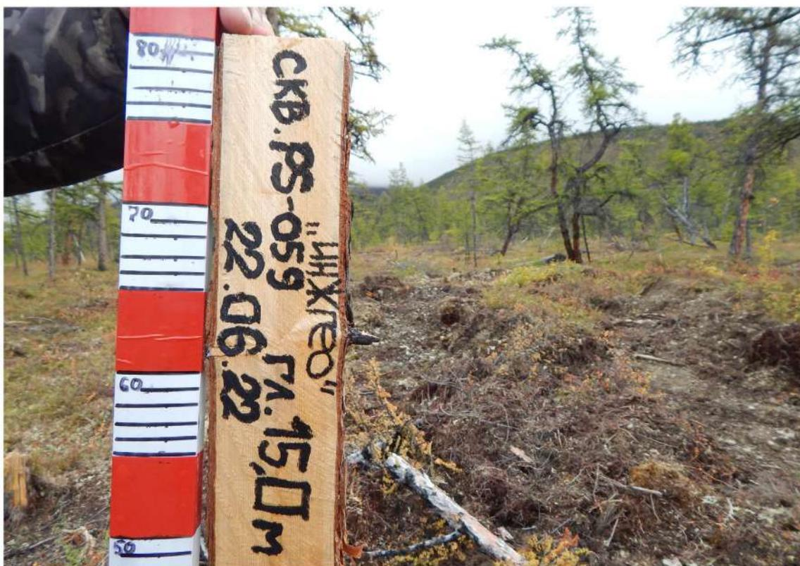
Рис. 27. Маркировка буровой разведочной скважины. Вид с запада.
