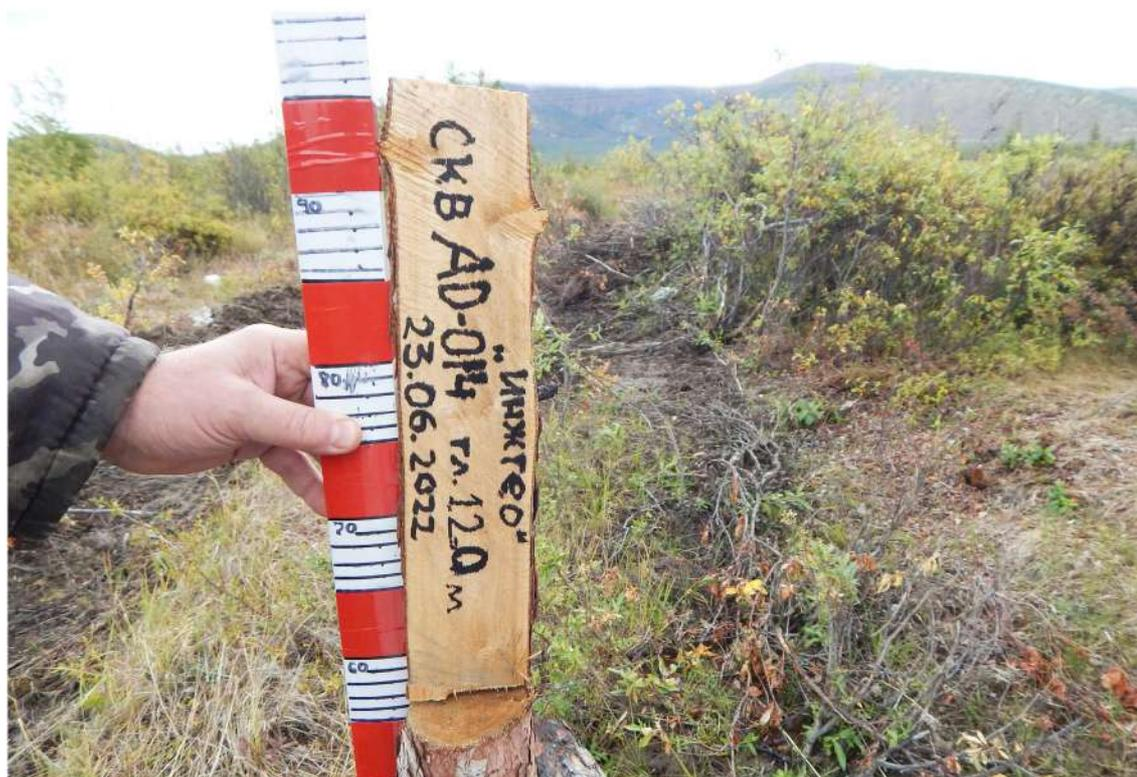
Рис. 15. Маркировка буровой разведочной скважины. Вид с запада.
