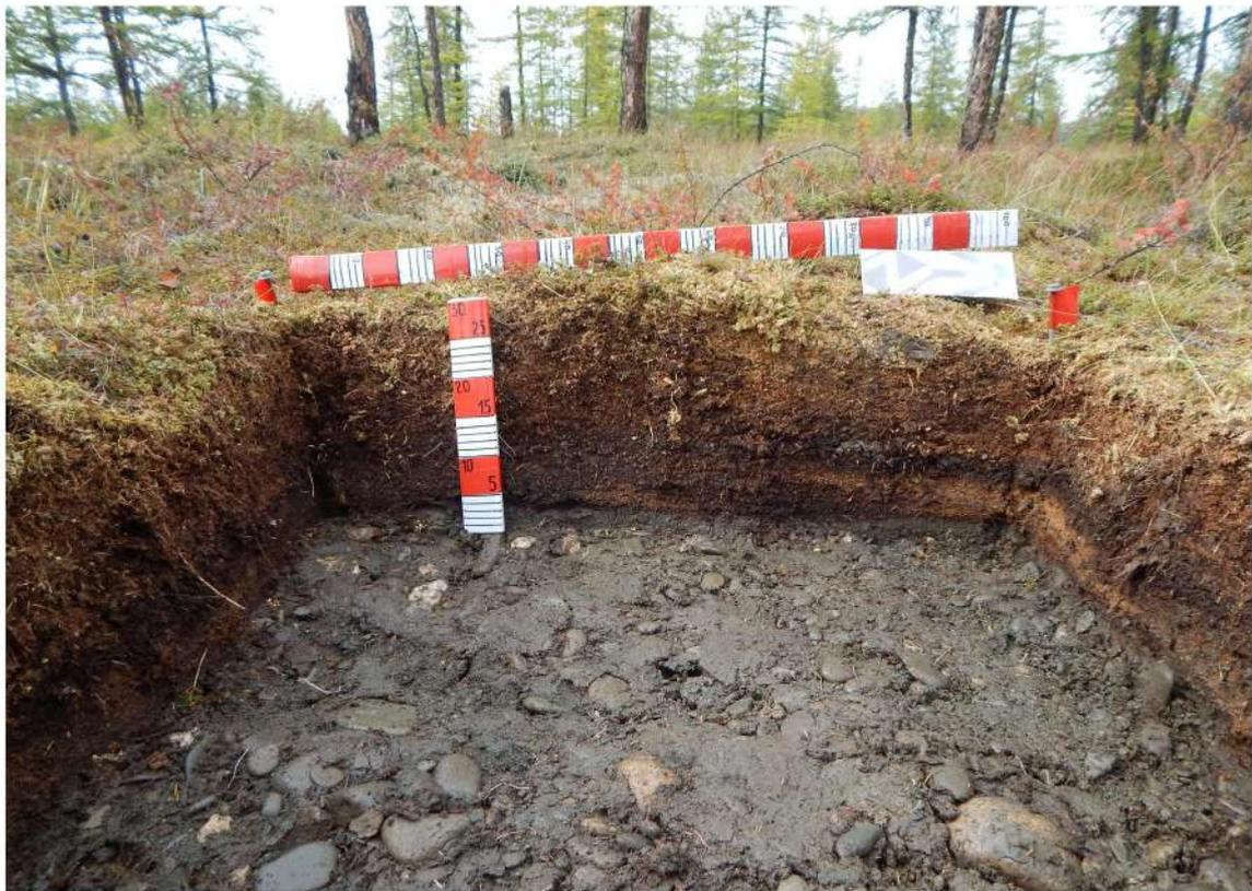
Рис. 74. Характер рыхлых отложений шурфа № 10. Западная стенка. Увеличение.
