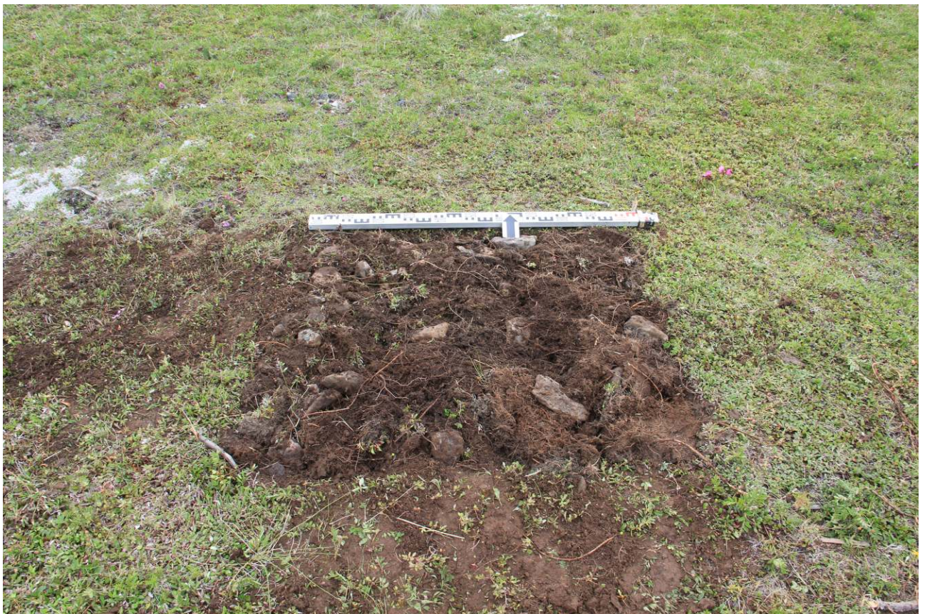
Рис. 62. Чукотский АО, городской округ Эгвекинот, 2022 год. Проект реконструкции аэропорта “Залив Креста”. Закладка шурфа на сохранившемся участке почв по борту ручья Дозорный. Рекультивация.
