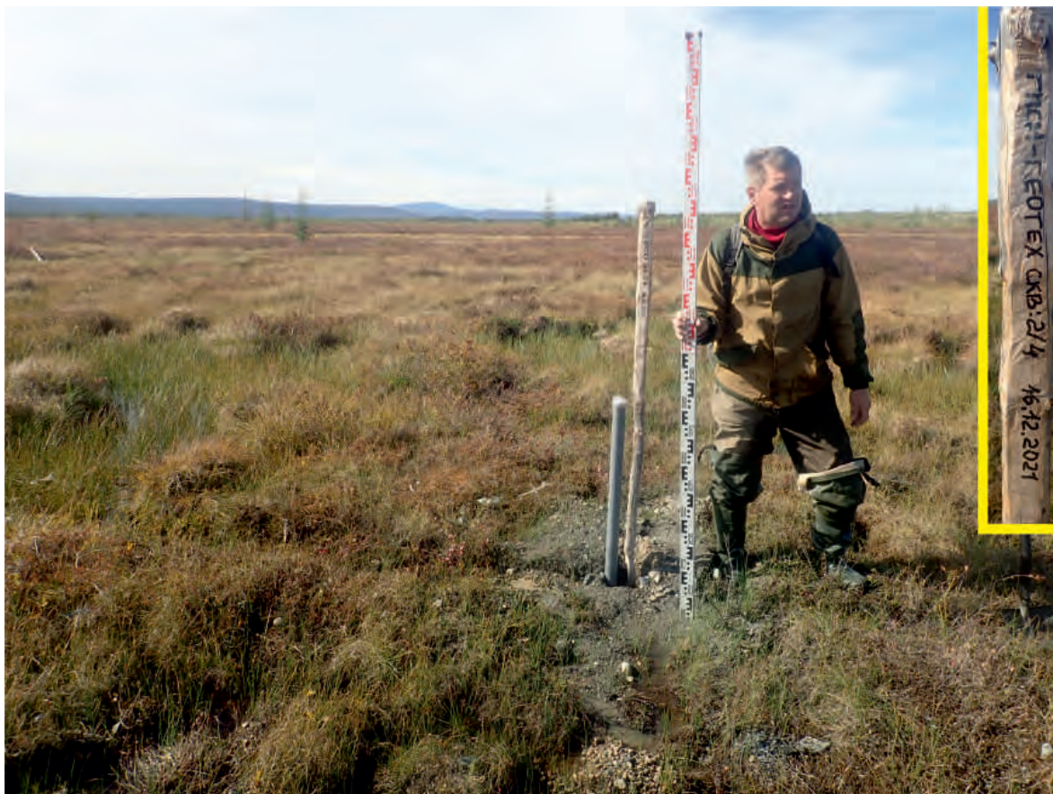
Рис. 250. СВАЭ-2022. Чукотский АО. Электроснабжение Баимского ГОК. ВЛ 330 кВ ПП Билибино-Баимский ГОК №2. ТФ 229 на участке 7. Буровая скважина в пойме Малого Анюя в районе створа. Вид с запада.
