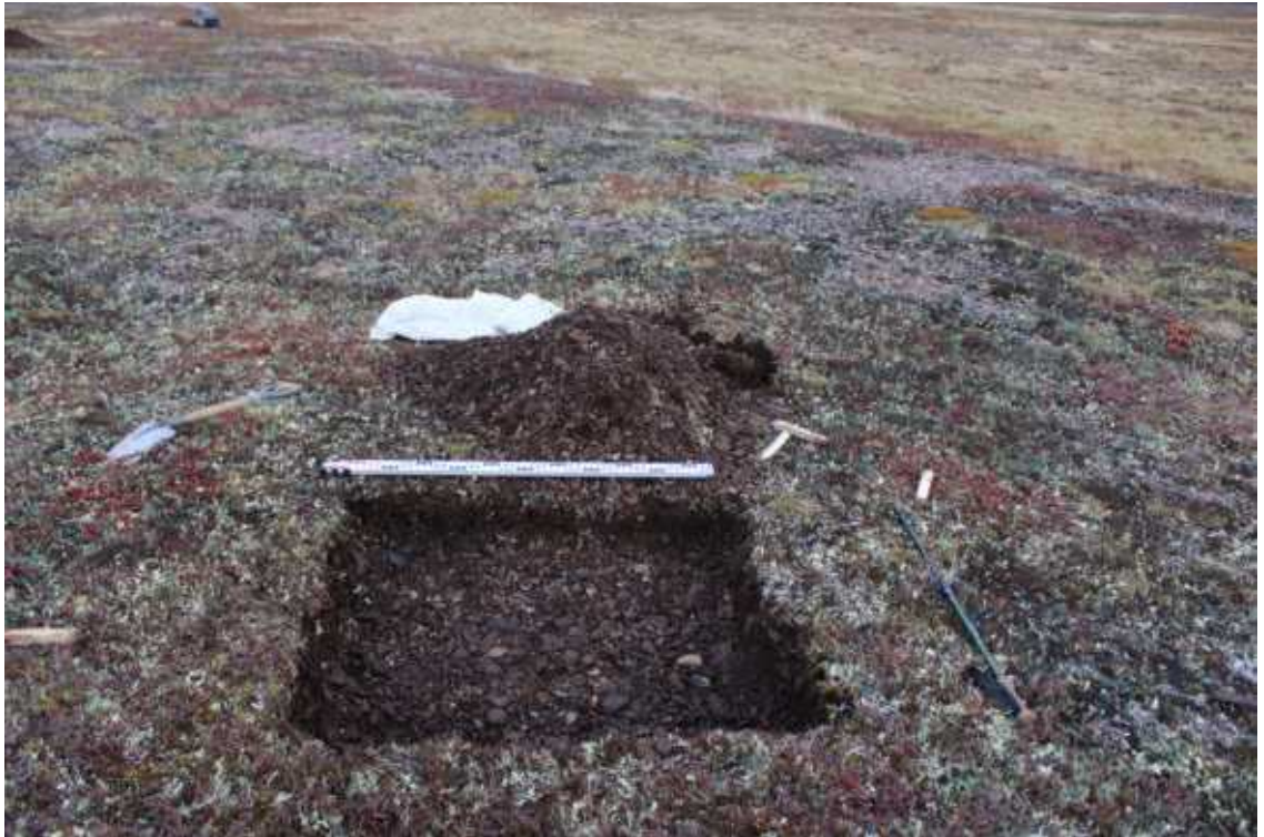
Рис. 492. Чаунский район ЧАО. Проектируемая трасса автодороги км.737. Левый борт долины р.Майнываам. Южная стенка шурфа №90. Вид с С.
