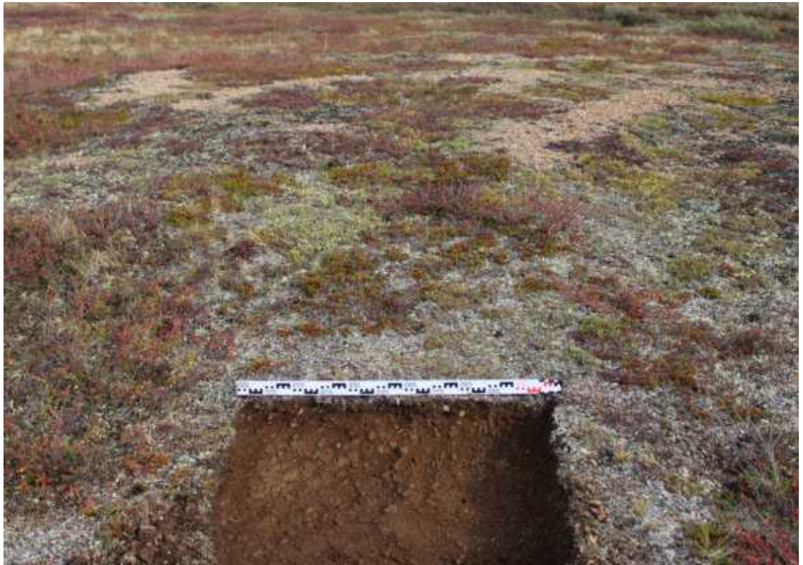
Рис. 162. Чаунский район ЧАО. Проектируемая трасса автодороги район км. 798. Восточная стенка шурфа №28. Вид с 3.
