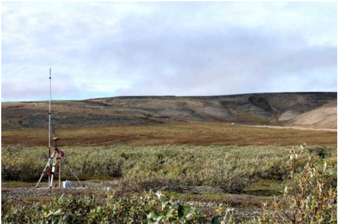
Рис. 329. Чаунский район ЧАО. Проектируемая трасса автодороги в районе км.754+150. Левый берег р.Пыкарваам. Базовая точка геодезической съёмки изыскателей ООО «Прогресс». Вид с ВСВ.
