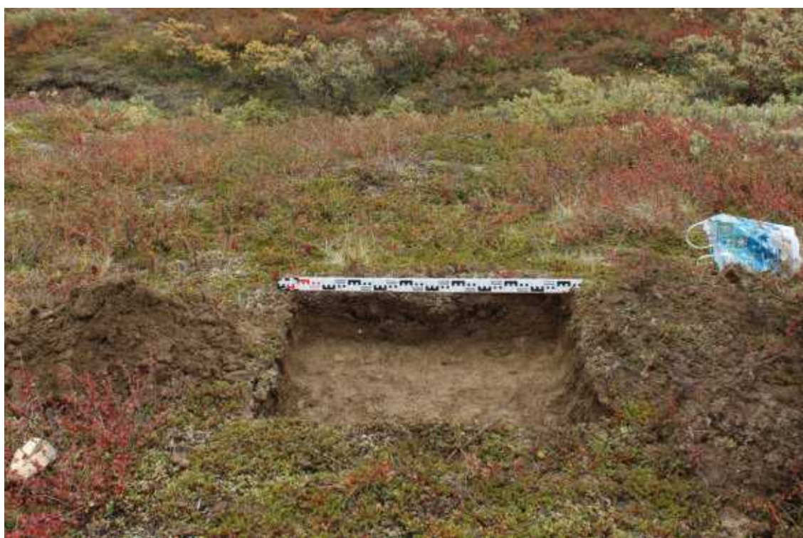
Рис. 276. Чаунский район ЧАО. Проектируемая трасса автодороги район км.765-км.764. Южный борт р.Эльгыкаквын. Восточная стенка шурфа №55. Вид с 3.
