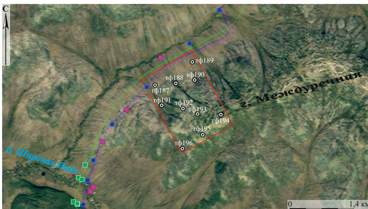
Рис. 319. СВАЭ-2022. Чукотский АО. Строительство автомобильной дороги от Баимского ГОКа до г. Билибино. Карьеры ОПИ. Участок 21. Расположение шурфов и точек фотофиксации на основе космоснимка Google (дата съёмки 09. 2020).
