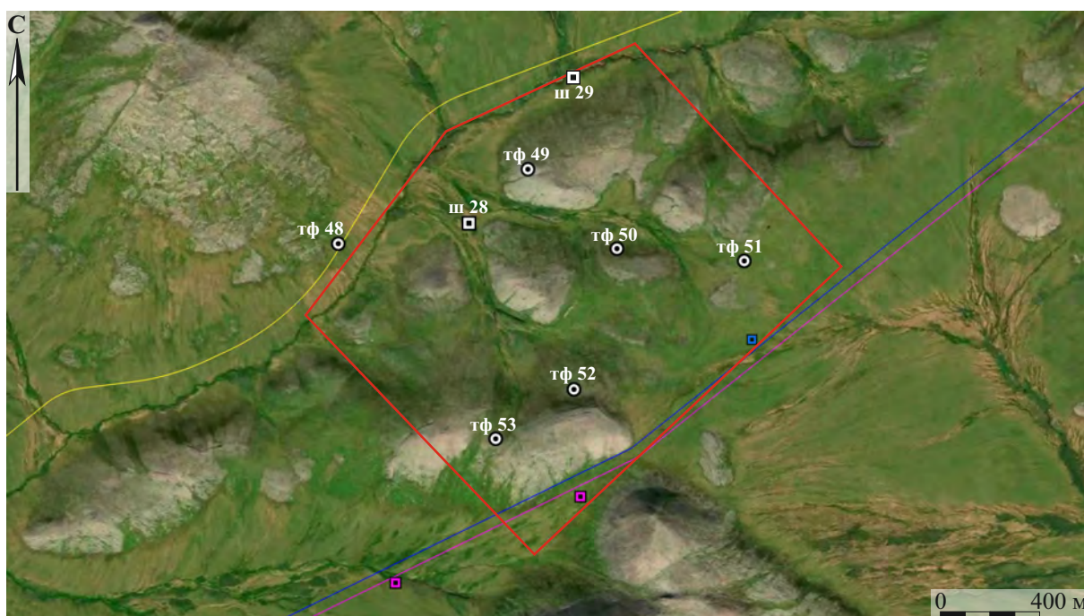
Рис. 176. СВАЭ-2022. Чукотский АО. Строительство автомобильной дороги от г. Билибино до мыса Наглёйнын. Карьеры ОПИ. Участок 47. Размещение шурфов и точек фотофиксации на основе космоснимка Google © (07.2018).
