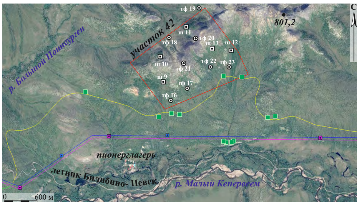
Строительство автомобильной дороги от г. Билибино до мыса Наглёйный. Карьеры ОПИ. Участок 42. Размещение шурфов и точек фотофиксации на основе космоснимка Google © (07.2018).
