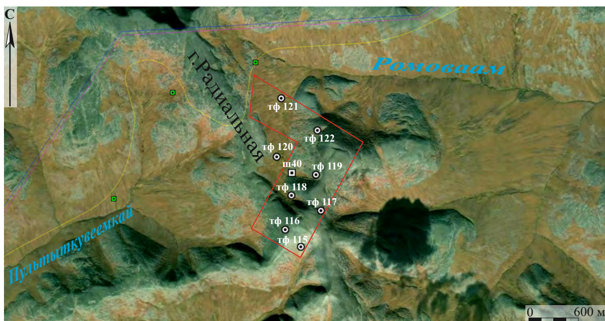
Строительство автомобильной дороги от г. Билибино до мыса Наглёйнын. Карьеры ОПИ. Участок 59. Размещение шурфов и точек фотофиксации на основе космоснимка ESRI © (07.2018).
