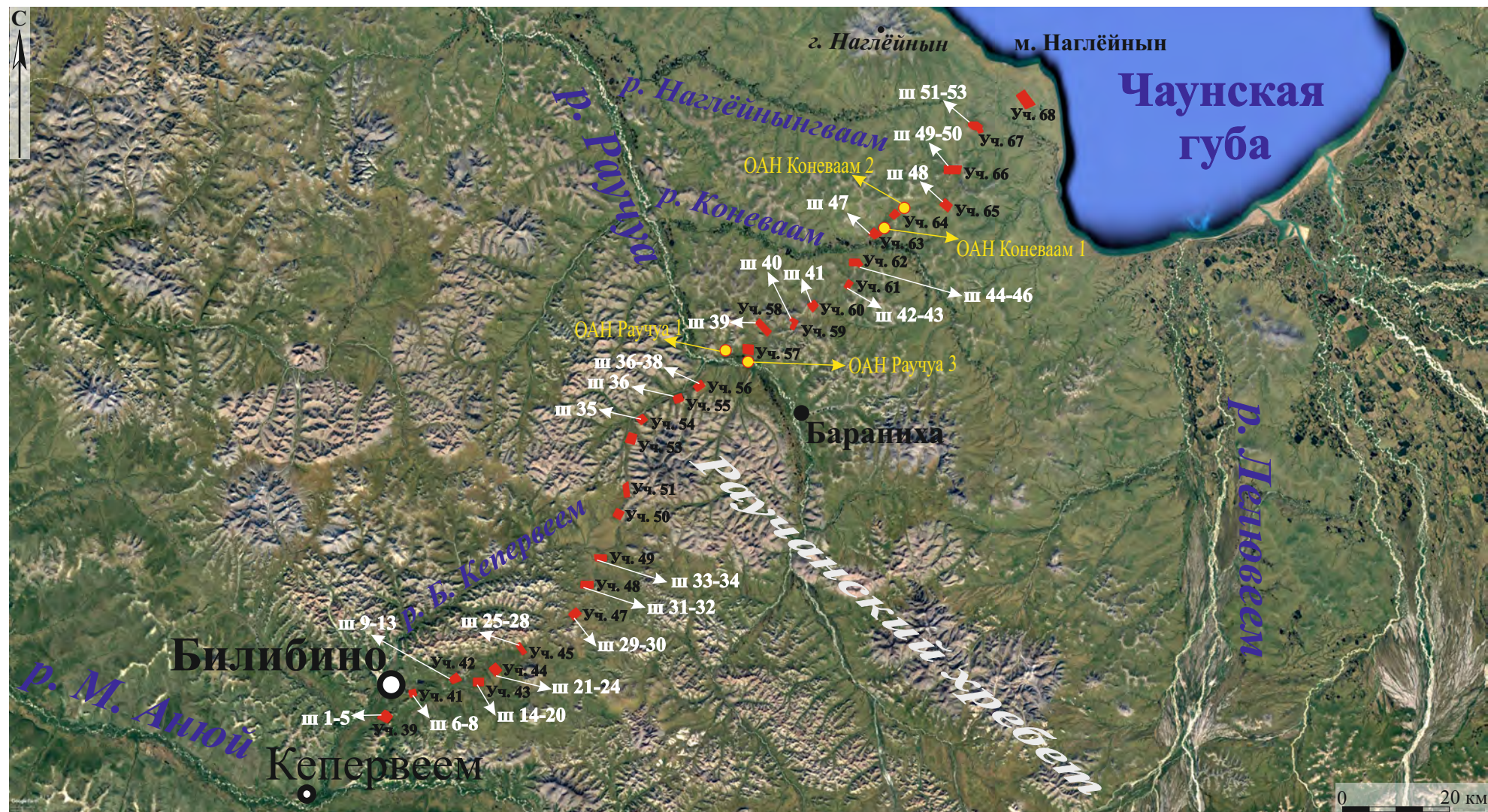
Рис. 4. СВАЭ-2022. Чукотский АО. Строительство автомобильной дороги от Баимского ГОКа до г. Билибино. Карьеры ОПИ. Размещение шурфов на основе космоснимка Google © (дата съёмки 02.2017) и расположение ближайших ОАН.
