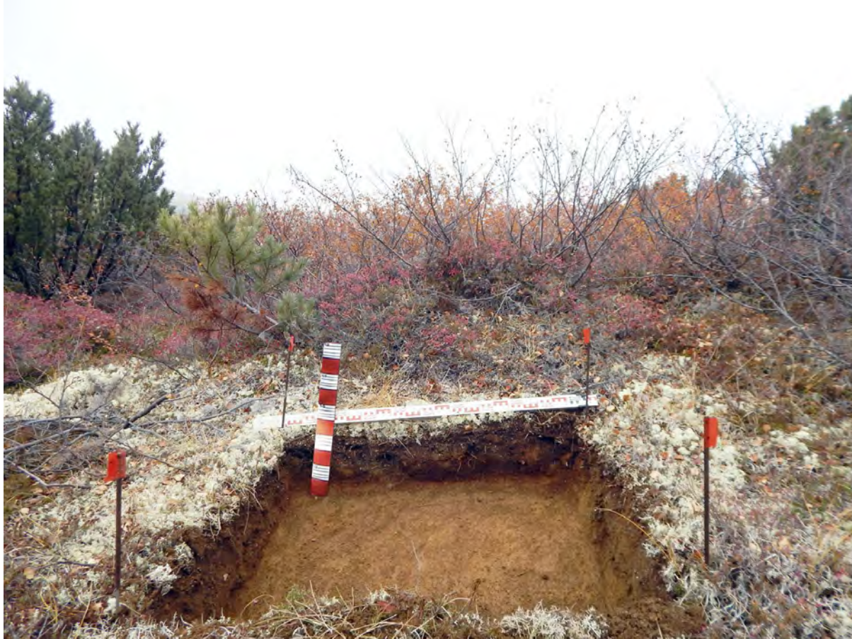
Рис. 118. СВАЭ-2022. Чукотский АО. Строительство автомобильной дороги от г. Билибино до мыса Наглёйнын. Карьеры ОПИ. Участок 43. Шурф № 20 после вскрытия. Вид с севера.
