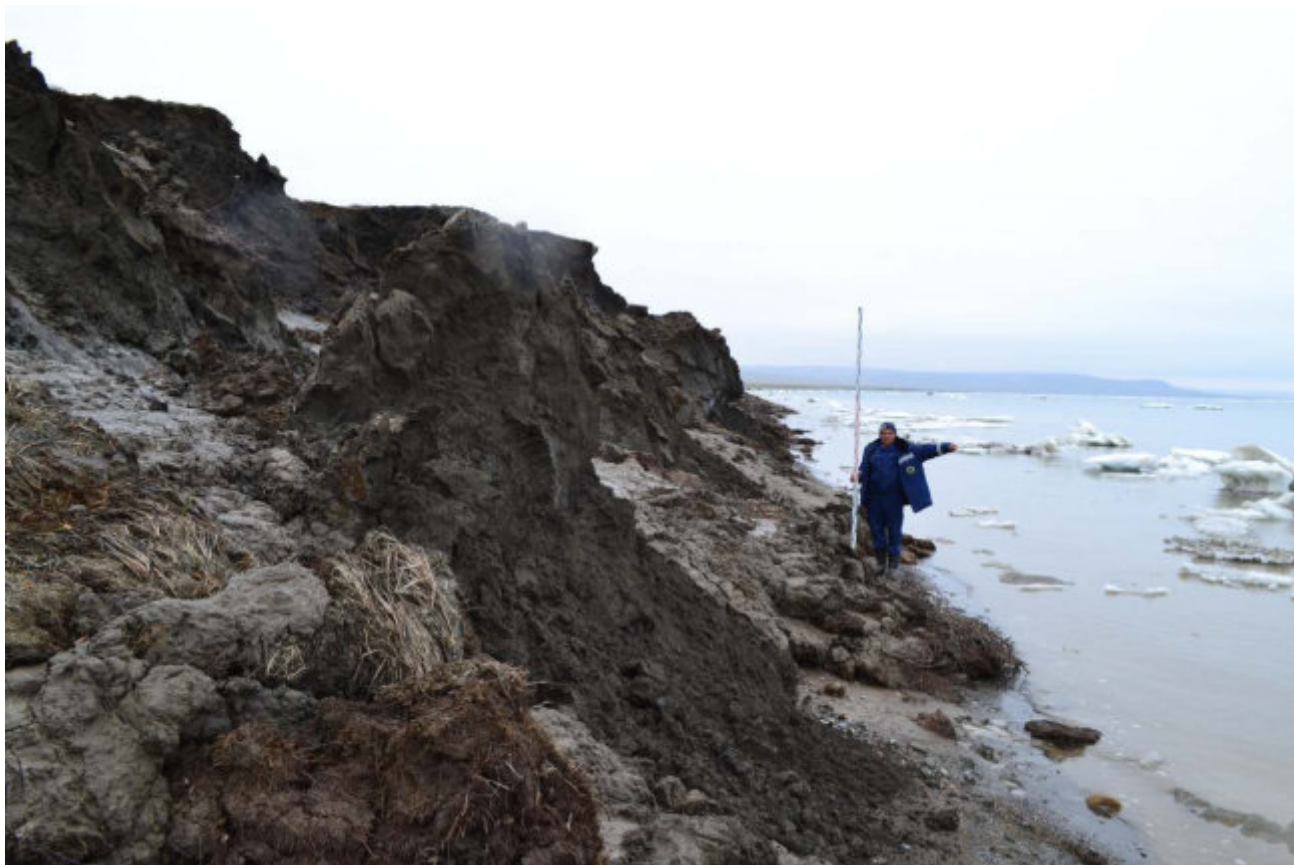
Рис. 458. Чукотский АО, городской округ Певек (Чаунский район), Месторождение “Ручей Факторийный”, 2023 год. Устье руч. Факторийный (за границами участка работ). Обрыв. Рыхлые породы над ледовой линзой. Вид на ВСВ. ТФ38.
