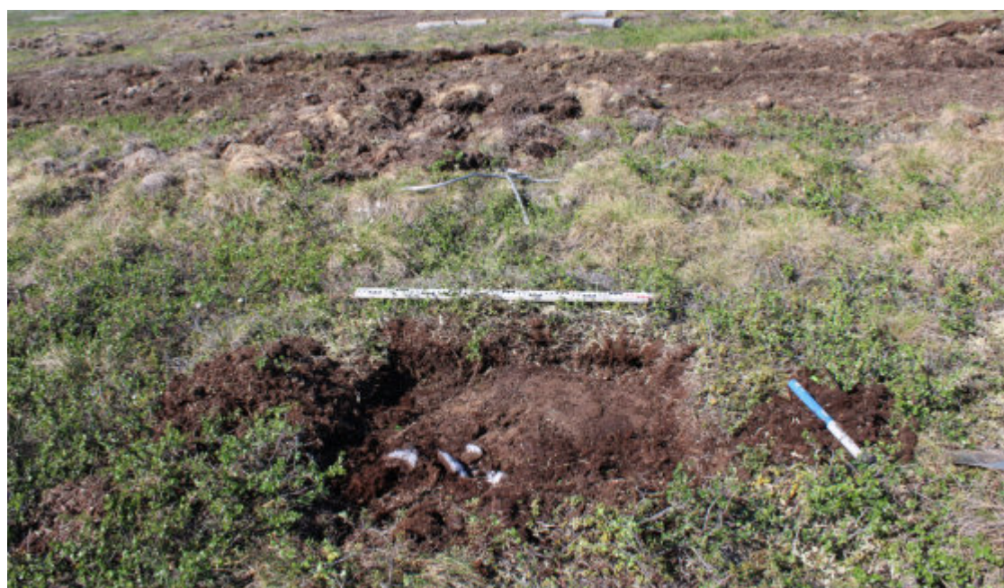
Рис. 42. Билибинский район ЧАО. Земельный участок объекта: «Склад АХОВ». Разбор шурфа №1. Фиксация линзы льда. Вид с Ю.
